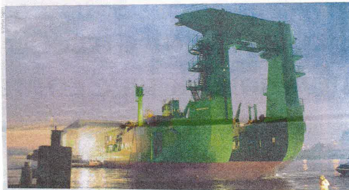
De nieuwe rotscutterzuiger Ambiorix kan tot een waterdiepte van 35 m zware grond en rots baggeren.
