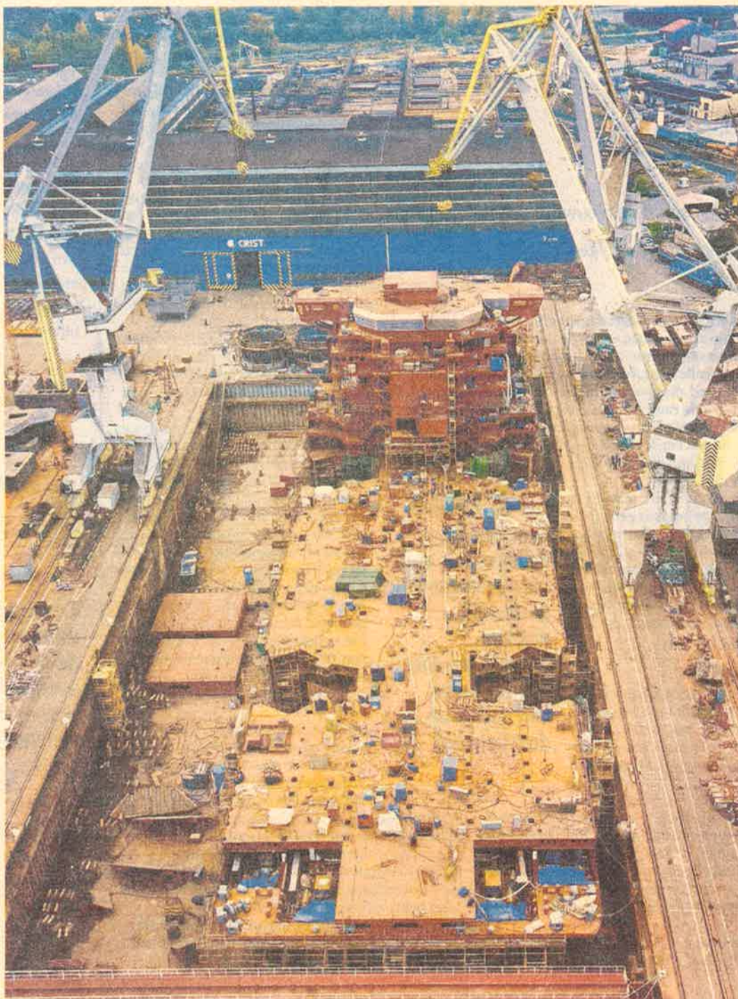
In het nieuwe 150 meter lange 'windmolenschip' van DEME is 23.000 ton staal verwerkt.
